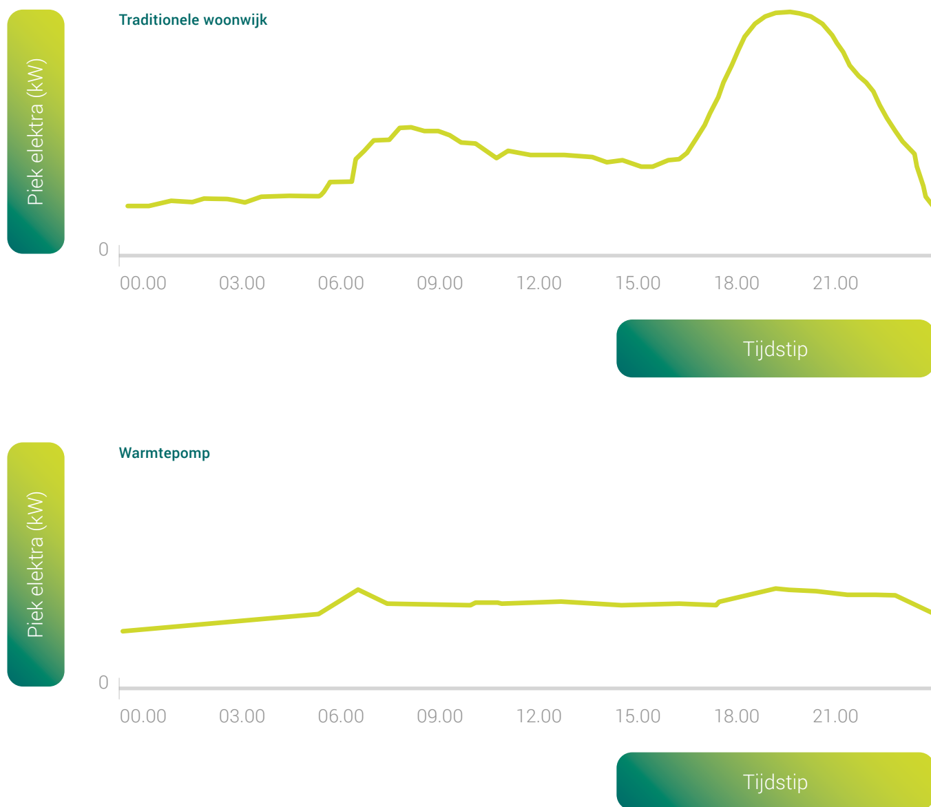
Figuur B7.3 Belastingsprofiel en belastingspiek traditionele woonwijk en warmtepomp (Bron: NBNL)
